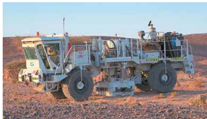
Az önjáró vibrációs jármű a föld belsejébe juttat alacsony frekvenciájú hullámokat, amelyek a különböző rétegekről visszaverődnek, és így képet lehet alkotni a földkéreg több kilométeres szerkezetéről
