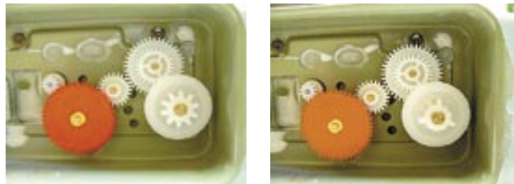
Ép és kitört fogú gázmérő-fogaskerekek (a rendőrség felvételei)
